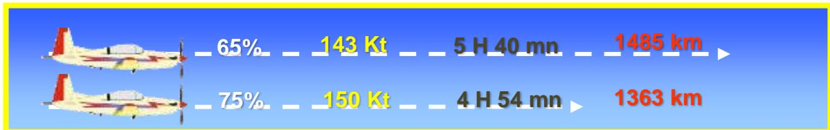
Moteur 200 Cv – 242 litres – Même niveau FL 75 – Même réglage mixture (-100°F)
