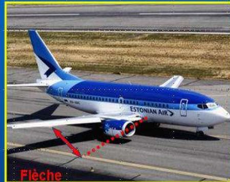
La flèche d'une voilure est exprimée en degrés. Elle peut être positive (vers l'arrière), négative ou nulle.
