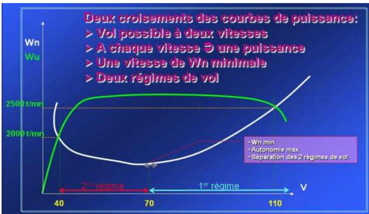
En considérant la courbe, le vol n'est possible qu'entre  $V_{min}$  (40) et  $V_{max}$  (110). Considérons le point de vol à la puissance minimale, au-dessus le vol est dit au premier régime, et en dessous le vol est au second régime
