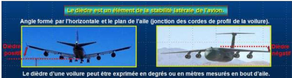
Le dièdre de la voilure intervient sur la stabilité latérale propre de l'appareil.
