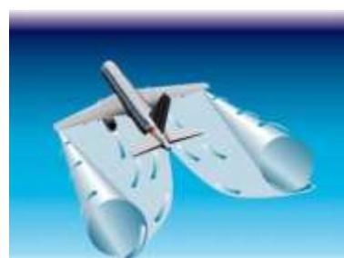
La traînée induite  $R_{xi}$  provient du fait qu'une aile ne possède pas un allongement infini. La suppression d'intrados tendant à compenser la dépression d'intrados, il s'ensuit un courant d'air du bas vers le haut initialement, puis par inertie, le mouvement étant déclenché, ce courant d'air effectue une rotation vers l'arrière d'où création des tourbillons situés en arrière du bout des ailes, ils s'appellent tourbillons marginaux.
