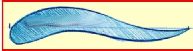
La position du Centre de Poussée recule lorsque l'incidence augmente (**autostable**).
