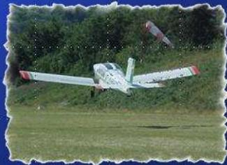
L'utilisation d'un faible braquage de volets (en général 10°, mais cela peut atteindre 25° suivant le type d'avion) permet de réduire la distance de roulement (ex : pour piste en mauvais état), mais diminue la pente de montée.
